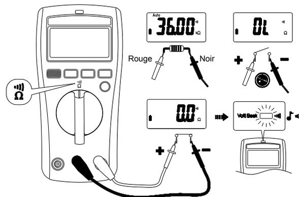
Tournez le commutateur rotatif et appuyez sur le bouton fonction pour sélectionner la mesure.
