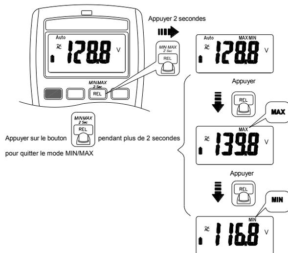
Le mode MAX / MIN enregistre les valeurs min et max d'une série de mesure. Lorsque l'entrée passe au-dessous de la valeur minimale enregistrée ou supérieure à la valeur maximale enregistrée, l'indicateur enregistre la nouvelle valeur. Appuyez sur le bouton Hold pour suspendre l'enregistrement.
