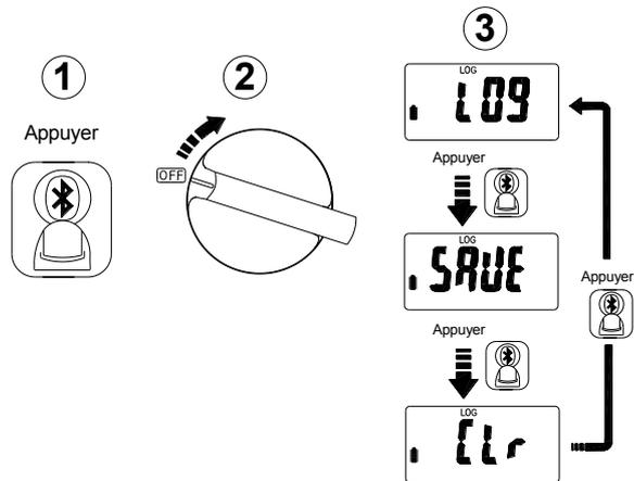
Appuyez sur le bouton Bluetooth lors de la mise en marche pour sélectionner le mode - mode enregistreur de données, mode d'enregistrement manuel et effacement de la mémoire.
