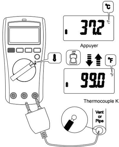
Tournez le commutateur rotatif et appuyez sur le bouton fonction pour sélectionner la mesure. (°C / °F)
