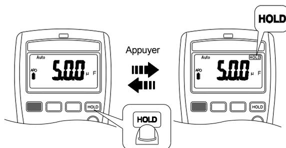
L'appareil émettra un bip continu et l'affichage clignotera si le signal mesuré est supérieur de 50 points par rapport à la valeur mémorisée. (Cependant, il ne peut pas détecter de tension / courant alternatif et continu).
