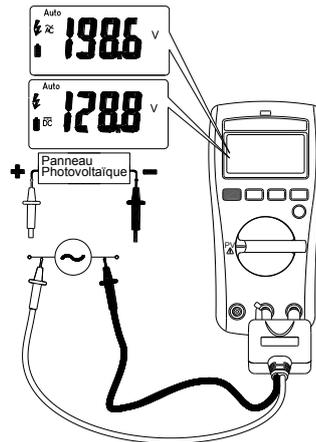
Tournez le commutateur rotatif et appuyez sur le bouton fonction pour sélectionner la mesure. Il est impératif d'utiliser les cordons optionnels SA163 pour effectuer cette mesure.
