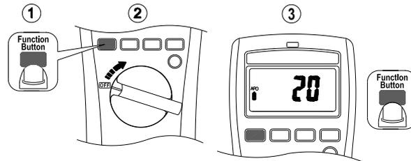
Appuyez sur la touche de fonction et allumez l'appareil. Appuyez ensuite sur la touche de fonction pour sélectionner le temps. Le temps peut être de 5 minutes, 10 minutes, 20 minutes et désactivé (AoFF).
