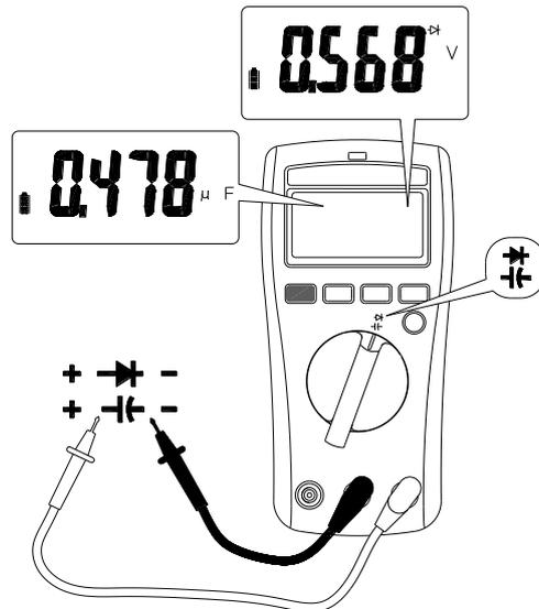
Tournez le commutateur rotatif et appuyez sur le bouton fonction pour sélectionner la mesure.
